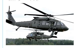
"黑鹰"长 19.76 米, 机 身宽 2.36 米, 高 5.13 米, 机 身为半硬壳结构。该机最 大起飞重量约10吨,最高 时速292公里, 航程603公
