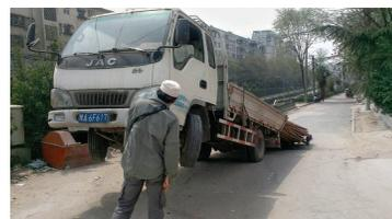
货车拉了百十根钢管去工地,不料,在爬坡拐弯时由于前轻后重,大量的钢管向外滑落,一下子将车头给悬空了。
