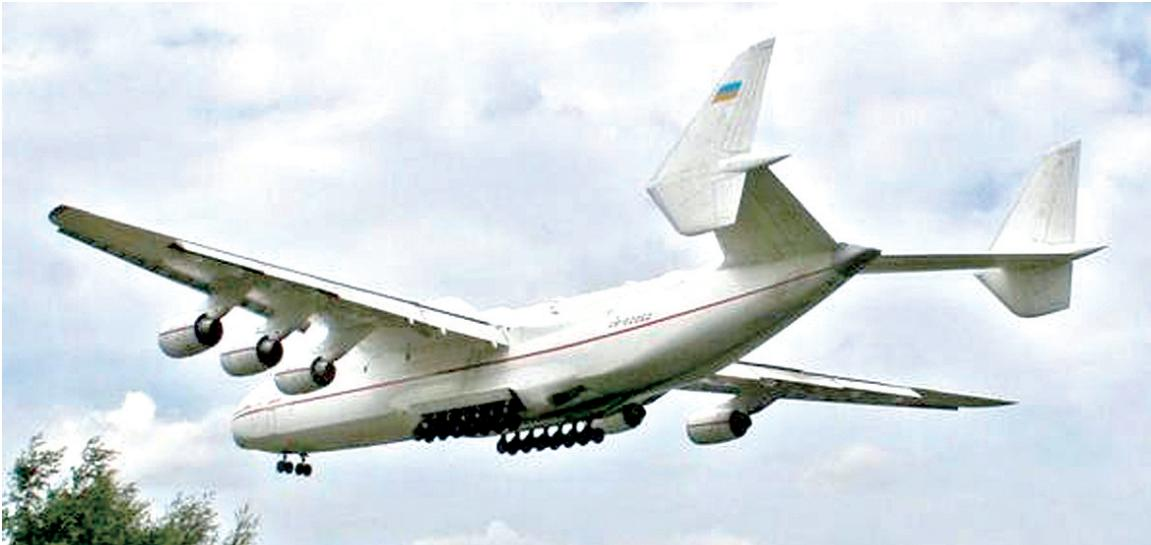
世界上最大的飞机——安托诺夫安-225“梦想”运输机,该机机身长84米、翼展88.4米、高18.2米,相当于5层楼高,最大载重量250吨,最大起飞重量620吨,可一次搭载16个集装箱或80辆轿车,也可在机舱外背负一座长70米、直径10米的精馏塔或一架“暴风雨”号航天飞机。北约代号“哥萨克”是一架离陆重量超过600吨的超大型军用运输机,是迄今为止全世界最大的运输机与飞机,由乌克兰所拥有、苏联时代的安托诺夫设计局开发作为苏联太空计划的设备运输用途,迄今为止仅制造过两架,在1988年12月21日首度试飞。
