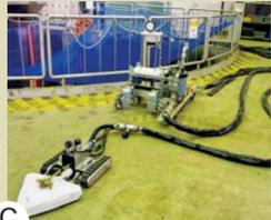
C 另一款机器人Raccoon已经开始在2号反应堆建筑的地板上工作,它身后拖着长长的管道,用于补给水和吸走垃圾。
