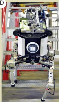
D 东芝公司研发了这款4足机器人,它能够在崎岖的表面行走,可绕过障碍,上下楼梯。除了装备有照相机和放射性剂量仪,它还携带有一个小型陪伴机器人,专门用于勘测狭小的地方。公司还计划给这款四足机器人添加手臂,让它能够安装防护罩、堵塞漏洞、搬运瓦砾。
