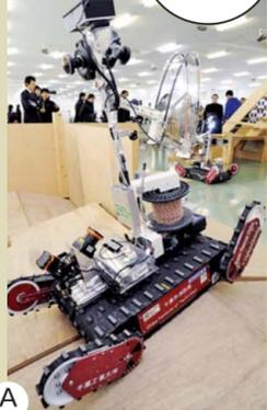
A 2011年夏,Quince成为第一款在反应堆建筑内执行检测任务的日本机器人,它安装有照相机和放射性剂量仪用以识别辐射热点。
