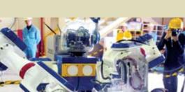
F 三菱重工奉献的这款机器人MHI-MEISTeR有两只手,能够使用多种工具,包括操纵电钻从混凝土墙壁和地板上采集样本。
