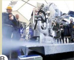
B 日立公司的这款机器人可以用于冰块对地板或墙壁表面进行研磨,将放射性物质和涂料、混凝土一起刮掉,并用真空装置将碎屑吸走。
