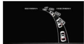
当车辆入弯时,后轮会跟随车辆同向转向,产生一定程度的转向角度,有效减少车辆因转向过度而产生甩尾现象。
