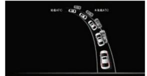
当车辆入弯,系统监测到车辆即将出现转向不足时,会对内侧双轮实时制动,通过自动协调内外轮转速,提升车辆的转弯性能,减少车辆因转向不足而产生推头现象。
