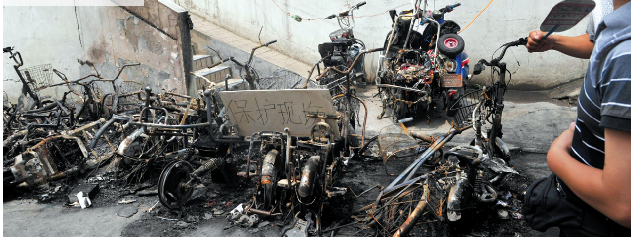
小区内因私扯电线充电引起火灾被烧毁的电动车。
