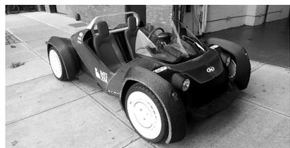
世界首款3D打印汽车终成现实,近日这辆汽车走上街头试车,外观奇特的它吸引了许多人的目光。 而据制作者称,整辆汽车的零件成本约为3500美元。 据悉,这辆由“本地汽车”公司打造的3D打印汽车只有两个座位,名字叫“斯特拉迪”,它的制作周期为44个小时,并且最高时速可以达到80公里。 报道称,“斯特拉迪”全身是碳纤维及塑料,利用“3D打印技术”制造而成。据悉,全车只使用了40个零件,且依靠电动能源,充一次电花费3.5小时,可以行驶大约100公里。 据凤凰网
