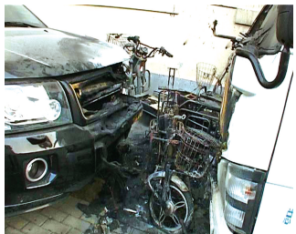
被封存的电动车充电引发的火灾现场。
