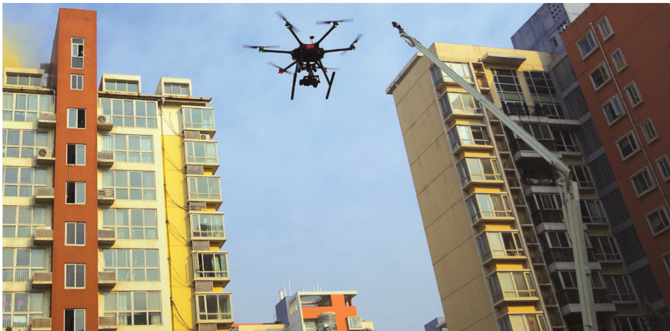
“六悬翼消防无人侦察机”进行火情侦察
