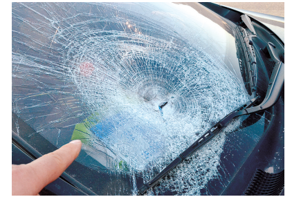
车前挡风玻璃上的网状裂痕
