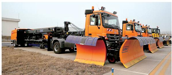
国等知名专业除冰雪设备品牌，每台车基本涵盖扫雪车、抛雪车、洒布车三个类型。其中，抛雪车最远能够将雪抛撒到30米远，积雪清除后，最后再用洒布车在道面上喷洒除冰液，防止道面结冰。
