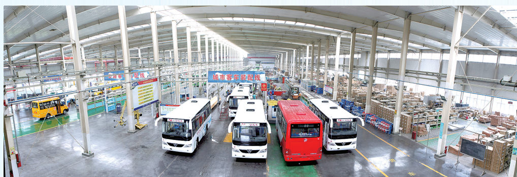
少林客车股份有限公司城市客车装配线
