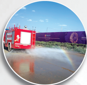
▲侯寨一工地洒水车进行降尘作业
