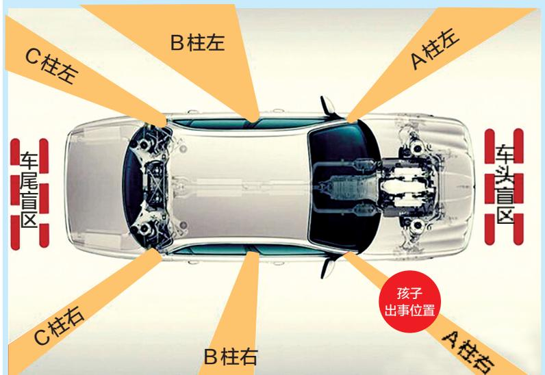
一般来说,盲区分为被动和主动,被动盲区一共有10个,分别分布在车头、车尾、A柱两侧、B柱两侧、C柱两侧以及左右后视镜;主动盲区有车内障碍、错误跟车、陡坡驾驶、错用远光等。
