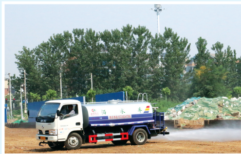
对辖区建筑工地进行洒水降尘
