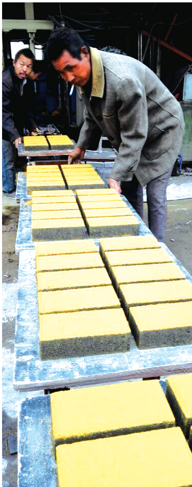
建筑垃圾处理后的粉末加工做成砖块,砖块的质量相当于市场上的普通水泥砖,但是价格比普通水泥砖便宜近一半。
