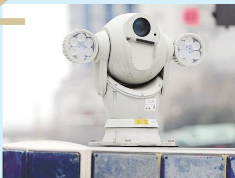
警车车顶安装了360度旋转高清探头，车内装有影像显示屏和摄像头操控器，一旦发现违法行为摄像头立即抓拍，主机对拍摄影像进行保存，对车辆行驶过程中的交通违章违法行为拍摄取证。
