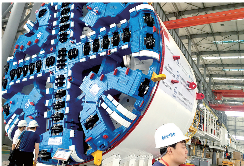
工人们正在组装直径7.5米的土压平衡盾构,这台盾构机将发往以色列。
