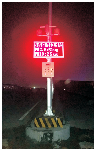
扬尘监控系统
