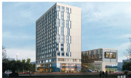
徐庄街便民服务中心项目位于郑东新区商鼎路和徐庄街交叉口东南角，总建筑面积33028.2平方米，地上15层，地下2层，总高度62.55米。地上建筑面积23278.0平方米，地下建筑面积9750.2平方米，总投资为2.3643亿元。主体施工单位为江西建工第三建筑有限责任公司，监理单位为河南省育兴建设工程管理有限公司。目前工程进度为主体工程完成，1~3层砌体完成90%，4层砌体完成40%，地下室安装工程完成50%。
