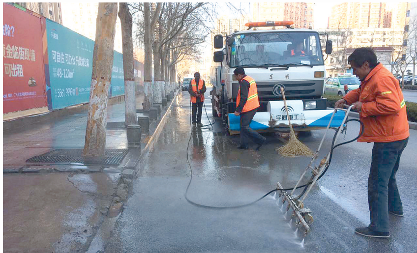
城管局对路面洒水防止扬尘
