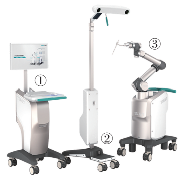
“天玑”骨科机器人由①主控台、②光学跟踪系统、③机械臂主机构成,分别相当于医生的脑、眼、手。
