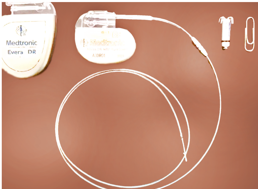
从左至右为:植入式心律转复除颤器、双腔起搏器及电极、无导线起搏器、曲别针
