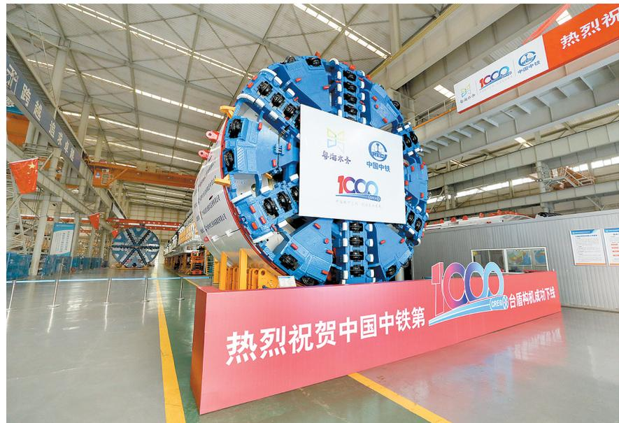
本报讯(记者 邓红超 徐刚领 王赛华/文 徐宗福/图)昨日,在郑州经济开发区中铁工程装备集团有限公司盾构总装车间,直径8.64米的土压平衡盾构机——粤海14号正式下线。这是具有里程碑意义的中国中铁自主研制的第1000台盾构机,将用于广东珠江三角洲水资源配置工程。
