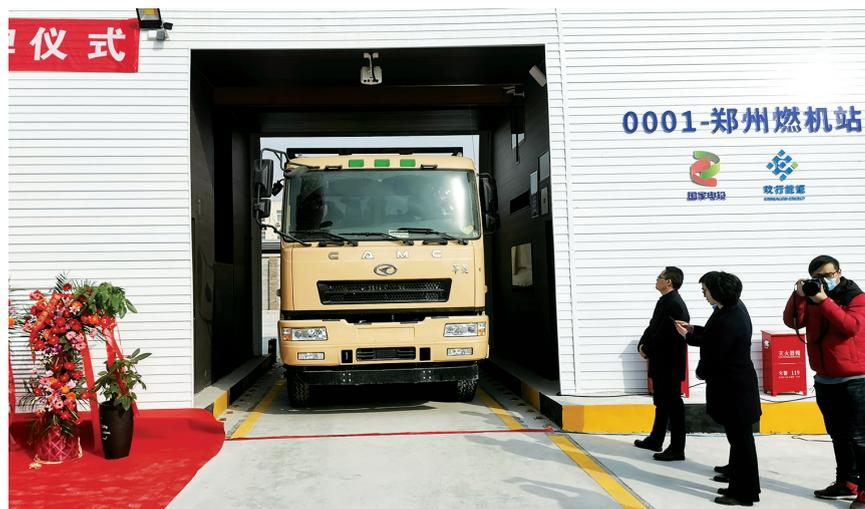
电池解锁,行吊自动抓取电池换至车身,换电过程最快仅需3分钟,电池充电仅需40分钟,实现了电池快速可持续充、换电,每天最多可充电100辆,实现24小时无人值班不间断运营。国电投(河南)新动力科技有限公司负责人程英姿介绍:“换电站实行快速吊装换电,相较于柴油重卡,每天可节约运营成本100多元,一年节约运营成本近4万元。国家电投河南公司首座充换电站的投运可实现电能替代大中型燃油机建车辆约100台,通过区域内重污染车辆的电动
