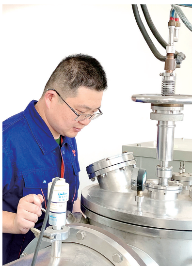
郑州机械研究所博士刘全明正在进行钎料合金真空熔炼及非晶箔带钎料制品研究
