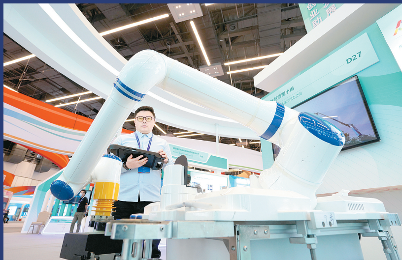
带电作业机器人 代替人工在电网上自由工作
