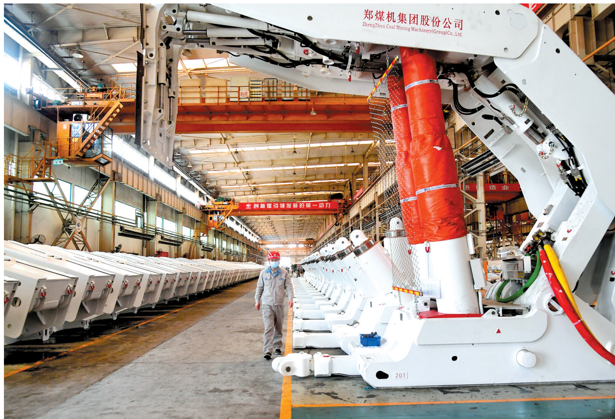
煤机成品车间内即将出厂的高低不同的液压支架 郑报全媒体记者 周甬 图
