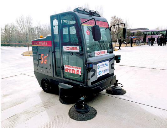
5G人工智能清扫车以及配套的5G远程驾驶舱
