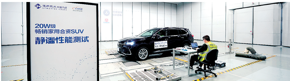
工作人员对别克昂科威Plus进行静谧性能测试
