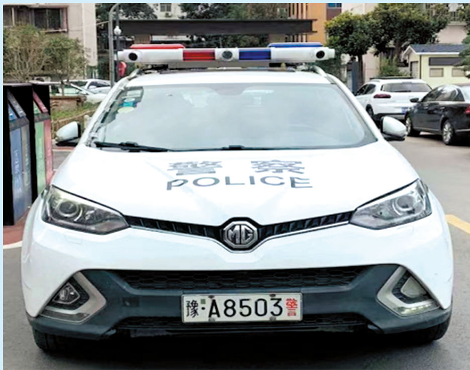
这就是违停抓拍利器,车顶搭载了6个全景式高清探头
