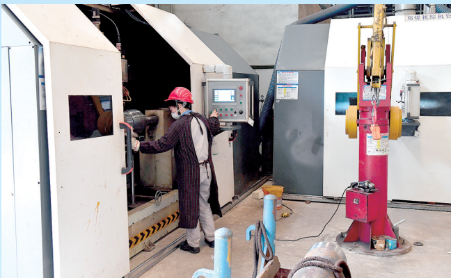
郑煤机综机公司生产车间铣削车床使用的“水循环除尘设备”
