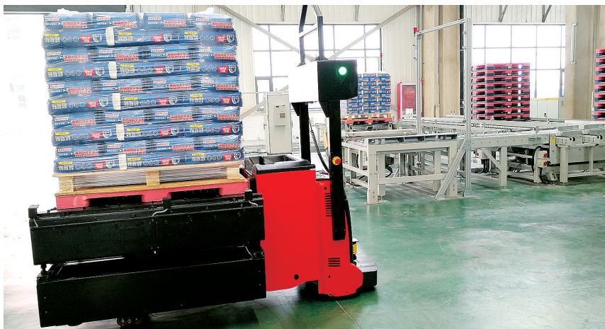
沙粉车间内,AGV智能化无人叉车在运输产品
