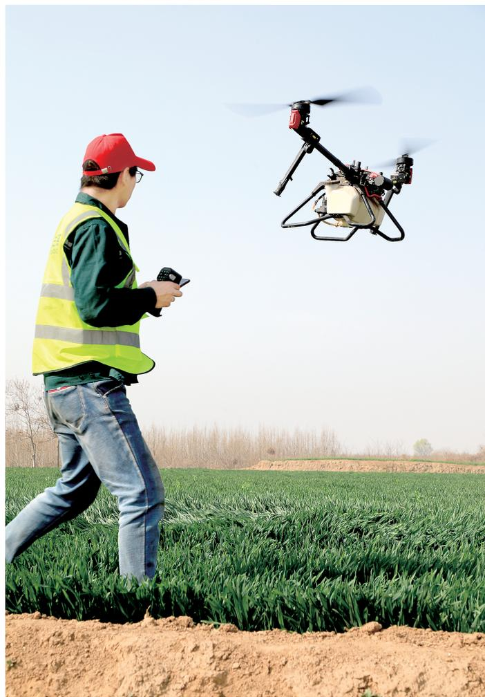
荥阳汜水镇赵村,技术人员用无人机进行喷洒作业(资料图片)
