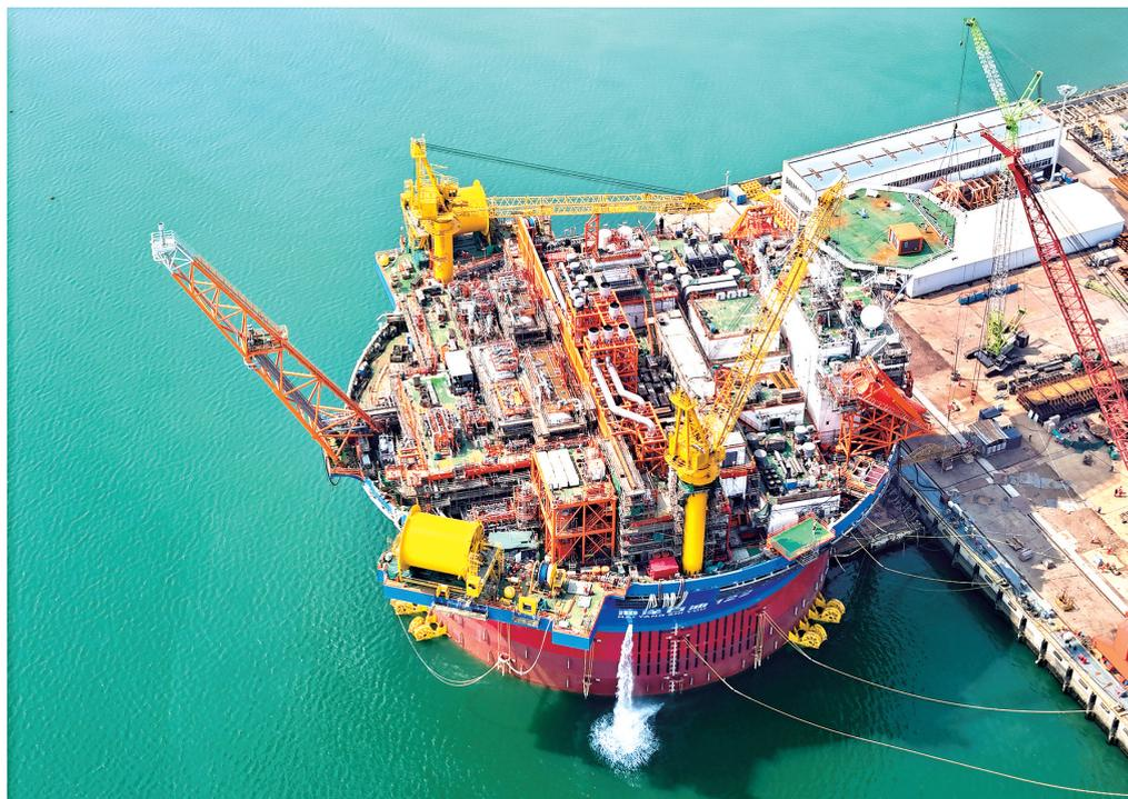
4月7日,“海洋石油122”浮式生产储卸油装置(FPSO)在海油工程青岛场地进行海上倾斜试验及调试(无人机照片)。
