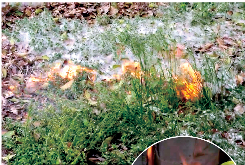
消防部门举行的杨柳絮燃烧实验现场
