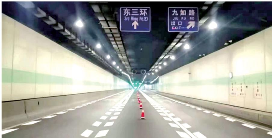
本报讯(记者 张玉东 通讯员 邢红军 文/图)喷涂纵向减速标线5935平方米、视错觉标线440平方米、更新升级双组份标线1702平方米、更新换代新国标线形诱导标志2734块……最近,在郑州市城市道路畅通委员会办公室的统筹部署下,郑州交警八支队深入推进市区快速路交通基础设施提升改造,通过更新完善提升各类交通基础设施,更好传递交通语言,规范车辆通行秩序。比如,八支队在东三环、北三环和京广路隧道内更新施划车行道纵向减速标线(俗称“鱼骨线”);在隧道出入口
