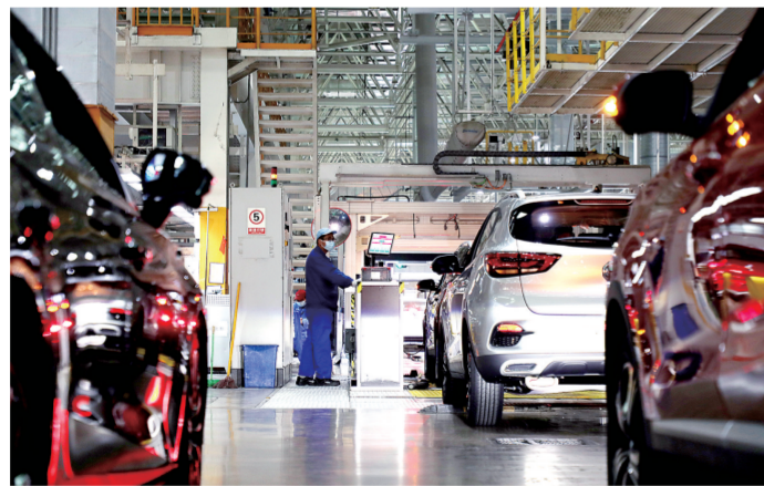
上汽郑州工厂生产车间内工作人员在对车辆进行四轮定位作业
