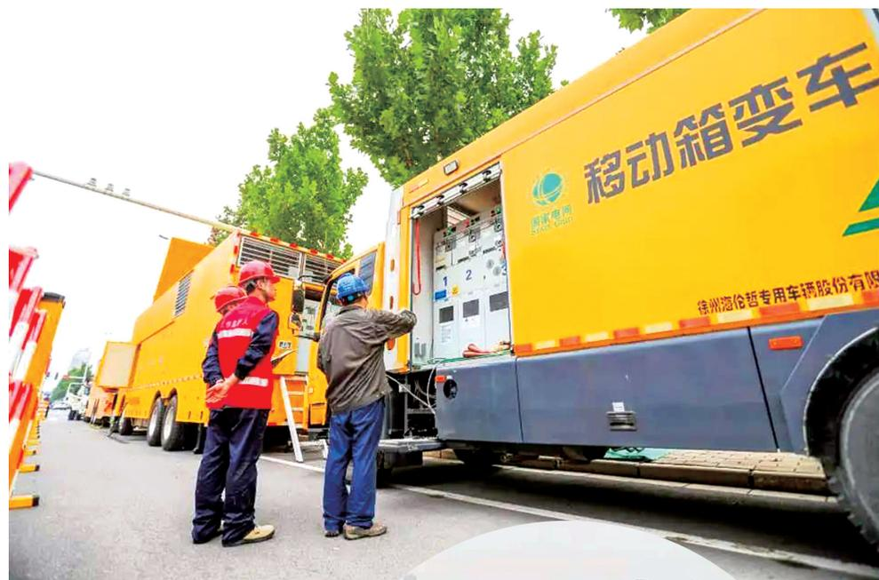
本报讯 4台黄色的大型车辆停靠在路边,发出巨大的轰鸣声,其中最大的一辆车的顶盖开启,蒸腾的热气让空气更加灼热……7月10日上午,位于郑州经开区经南十四路与明理路交会处,一台3000千瓦中压发电车正在开足马力为附近居民小区进行发电作业,一旁停驻的移动箱变车、低压发电车、油料运输车共同辅助作业。这是河南省内首台,也是国内最大功率的一体式发电车在郑州的正式亮相。
