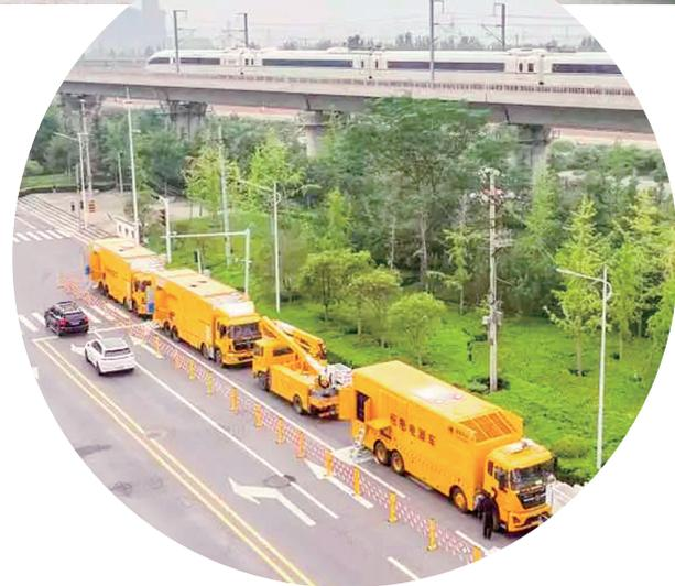
随着机器的轰鸣声通过移动箱变车、低压发电车、小区分支箱被送至居民楼。
