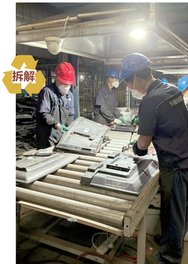
平板电视拆解线，工人将电视后壳拆下
